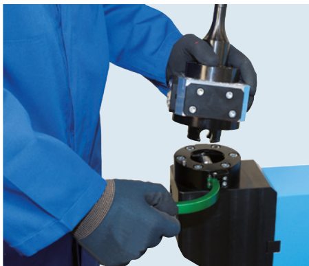
Schnellwechselsystem der Werkzeugträger Quick-change system of the tool holders
