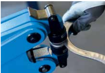
Stauchen und Strecken an U-Profilen / Shrinking and stretching on U-profiles
